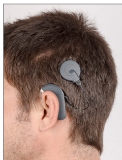
Obr. 5 Audio procesor SONNET za uchem a cívka na místě implantátu
