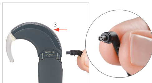
Obr. 15 Připojování kabelu cívky k řídicí jednotce
