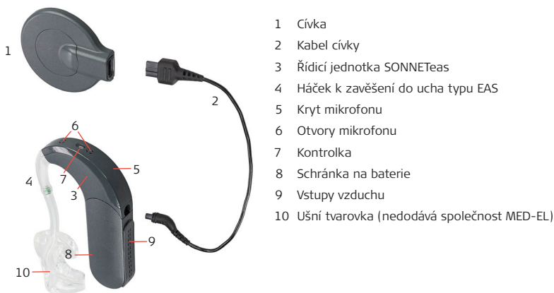
Audio procesor SONNETeas s připojenou ušní tvarovkou
