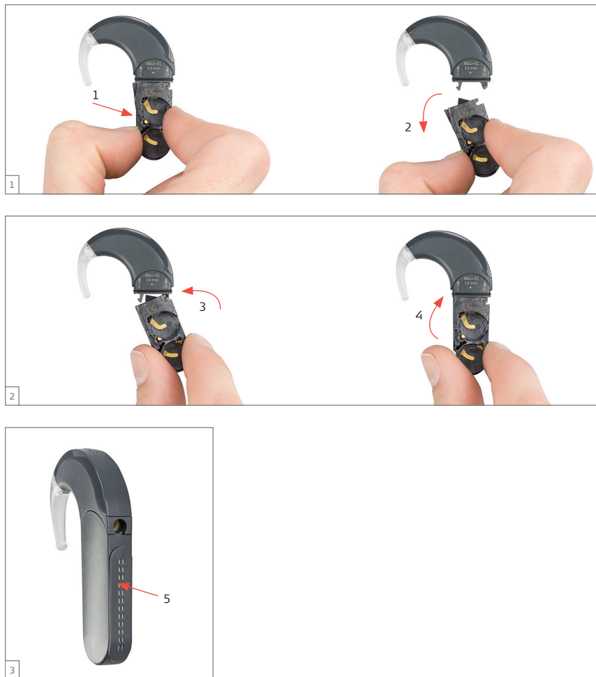
Obr. 8 Jak vymout schránku na baterie z řídicí jednotky a jak ji k ní opět připojit
